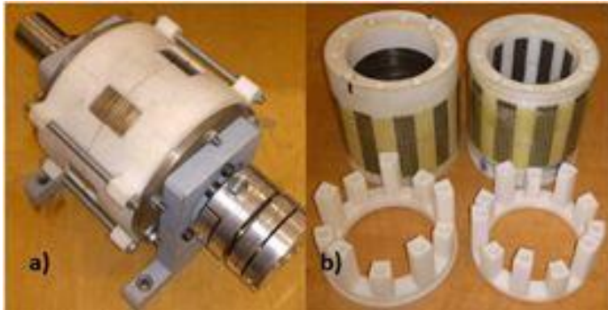
Rys. 1. a) Przekładnia o strumieniu promieniowym, b) modulatory – od lewej pakiet blach w kier. osiowym oraz kompozyt magnetyczny, Somaloy 700
