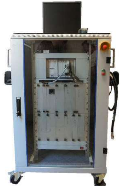
Rys.10. Schemat blokowy systemu diagnostycznego „Capacity Discharge” oraz opracowany na WEiA PG prototyp
