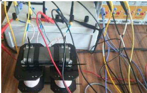
Rys.2. Transformatory średniej częstotliwości: a) transformator jednofazowy o modyfikowalnej strukturze WEiA PG, b) transformator trójfazowy zaimplementowany w układzie Dual-Active-Bridge - SuperGrid
