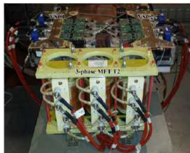
Rys.2. Transformatory średniej częstotliwości: a) transformator jednofazowy o modyfikowalnej strukturze WEiA PG, b) transformator trójfazowy zaimplementowany w układzie Dual-Active-Bridge - SuperGrid
