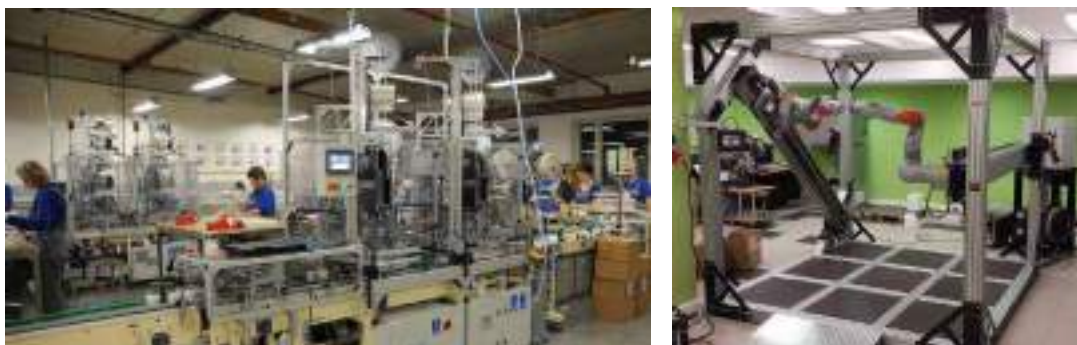
Automatyczna linia technologiczna do pakowania świec (zdjęcie lewe) oraz stanowisko do badania interakcji robot – człowiek (zdjęcie z prawej strony)
