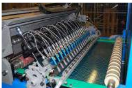
Linia technologiczna konstrukcji firmy ARET do produkcji palet z tektury falistej
